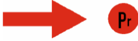
Şekil 10. Bilgi işaretleri – akış yönü ve basınç çıkışı.
